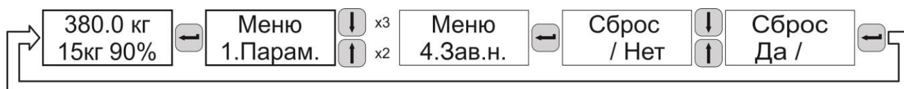
Рисунок 10 – Структура функции сброс к заводским настройкам.
