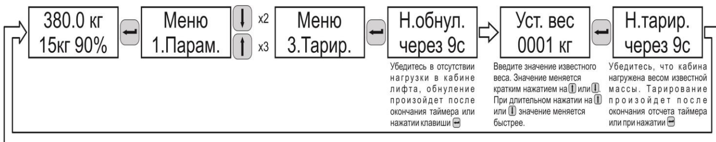
Рисунок 9 – Структура функции тарирование
